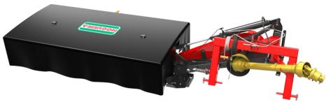
La Segadora SDN 210, es constituida de 5 discos de cortes ovales, con 2 cuchillas en cada disco, siendo, una cuchilla izquierda y otra derecha, que pueden ser utilizadas de los dos lados, diseñadas para producir un corte preciso no preyudicando la planta, lo que permite un rebrote más rápido.
